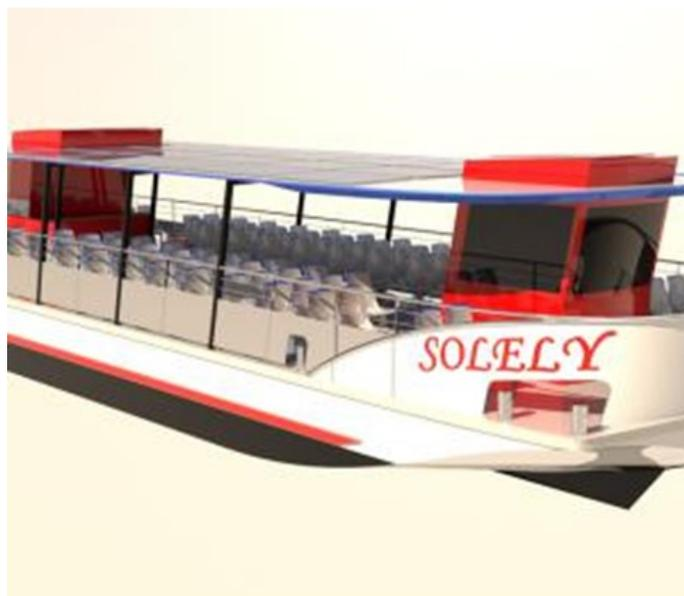
Long de 18m5 large de 5m1 avec un déplacement de 27 tonnes il est propulsé par 4 moteurs de 25KW
