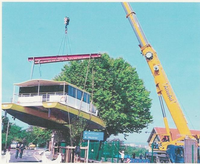
Elle aura fonctionné du 15 août à la fin octobre avec succès : catamaran fonctionnant avec un moteur électrique 24 kw alimenté par des batteries rechargées la nuit à l'usine hydroélectrique de Cusset et le jour, à 30% par des panneaux photovoltaïques sur le toit du bateau ; il a transporté, 3 fois par jour environ 60 personnes à chaque voyage.
